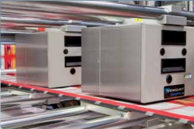
La impresora DataFlex Plus de Transferencia Térmica (TTO) ofrece imágenes de alta resolución en empaque flexible, que minimiza tiempos de inactividad y costos relacionados con roturas de cinta y cambios de producción. Para el marcaje variable de información como fecha, hora, número de lote, ingredientes, logos e información de marketing sobre películas del empaque flexible, etiquetas o tarjetas brillantes, este sistema proporciona lo último en productividad y eficiencia.
